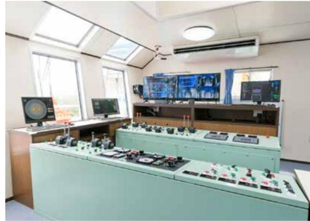
◀船内ネットワーク構築で全データを共有し、GNSSと海底ソナーを用いた施工管理システムにより、高精度な浚渫作業を実現。AIS装置により航行船舶の位置を可視化し、安全なタイミングで船体移動が可能。操船室ではあらゆる情報をモニタリングでき、クレーン作業との円滑な連携を図りながら一括操船が可能。
