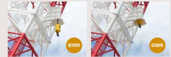
▲備品の荷役等多目的に使用できる補巻フックは専用の格納ポケットへ格納可能。
