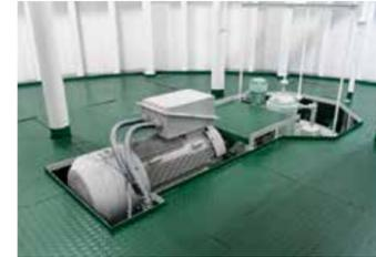
▲船首、船尾に配備した2台の新型電動可変方向型ポンプジェット式スラスターで自由自在な操船が可能。
