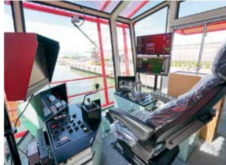
▲オペレータールームは従来より幅広設計とし、施工管理システムモニターを配置。操船室と情報共有して正確な浚渫作業が可能。浚渫時には水平掘装置制御により、平坦な施工が可能。
